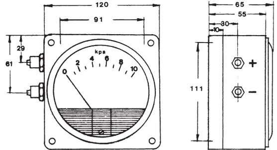
4 Bohrungen für Montage des Gehäuses (91 × 111)
